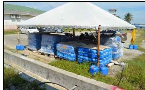
Pusat Latihan Bomba, PU Kuantan - Fire-Fighting Foam Diletakkan di Lokasi Sementara yang Terdedah Kepada Cuaca Panas (11.07.2017)
