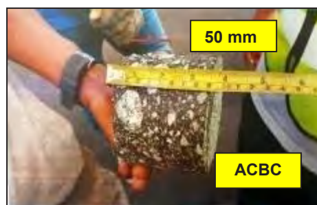
CH 44625, CH 44775 dan CH 44375 - Ketebalan ACBC Tidak Mengikuti Spesifikasi (14.04.2017)
