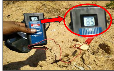
Blok 4, Ladang Sejahtera Ganda - Jumlah Kekuatan Voltan Pagar Elektrik yang Melebihi Standard yang Ditetapkan (08.02.2017)
